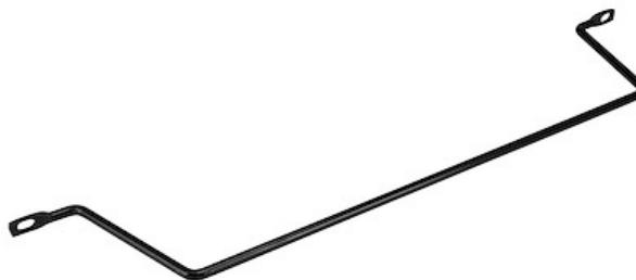
Diese Führungsschienen werden horizontal an der Vorder- oder Rückseite Ihres Racks installiert und bieten einen sicheren Montagepunkt zur Führung von Kabeln. Sie können Ihre Kabel mithilfe von Kabelbindern anbringen, um den Zug an den Kabeln zu reduzieren und Schäden an den Anschlüssen Ihrer Rack-Geräte zu vermeiden. Die Führungsschienen sind für mühelosen Zugriff um 10 cm versetzt.
