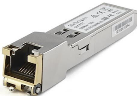
Der CTPSFP1GETST ist ein Juniper CTP-SFP-1GE-T-kompatibles Kupfer SFP-Transceiver-Modul, das für den Einsatz mit Juniper® Marken-Switches und -Routern entwickelt, programmiert und getestet wurde. Es sorgt für zuverlässige 1 GbE-Konnektivität über Kupfer-Kabel für 1000BASE-T-konforme Netzwerke mit einer maximalen Entfernung von bis zu 100m.
