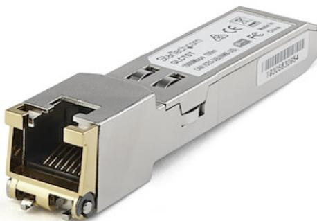
Le CTPSFP1GETST est un module de transceiver SFP cuivre compatible Juniper CTP-SFP-1GE-T qui a été conçu, programmé et testé pour fonctionner avec des commutateurs et des routeurs de marque Juniper®. Il vous assure une connectivité de 1 GbE par câble en cuivre, sur les réseaux compatibles 1000BASE-T et sur une distance maximale de 100 m.
