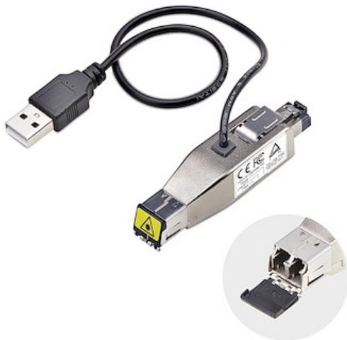
Este conversor compacto de fibra Gigabit a Ethernet permite actualizar el cableado Cat6 o similar a una conexión de fibra sin EMI. El adaptador, que cumple con la normativa TAA, está diseñado con un práctico cable USB integrado para la alimentación, lo que lo convierte en la opción perfecta cuando no se dispone de opciones de alimentación externa.
