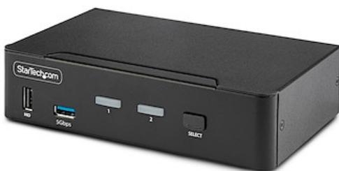
Teilen und schalten Sie zwischen zwei USB-A und DisplayPort-fähigen Computern um, indem Sie diesen DisplayPort KVM-Switch benutzen. Teilen Sie einen 8K 60Hz DisplayPort-Bildschirm, eine Tastatur und Maus, zwei USB 5Gbps Geräte und zwei zusätzliche USB 2.0 Geräte.
