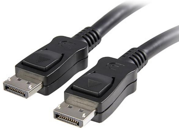
El Cable DisplayPort de 6 metros, DISPLPORT20L soporta un máximo de ancho de banda de hasta 10,8 Gbps, ofrece mayor rendimiento que cualquier otro cable HDMI o DVI de enlace dual y permite aplicaciones multimedia de última generación con una resolución máxima de WQXGA (2560 x 1600).
