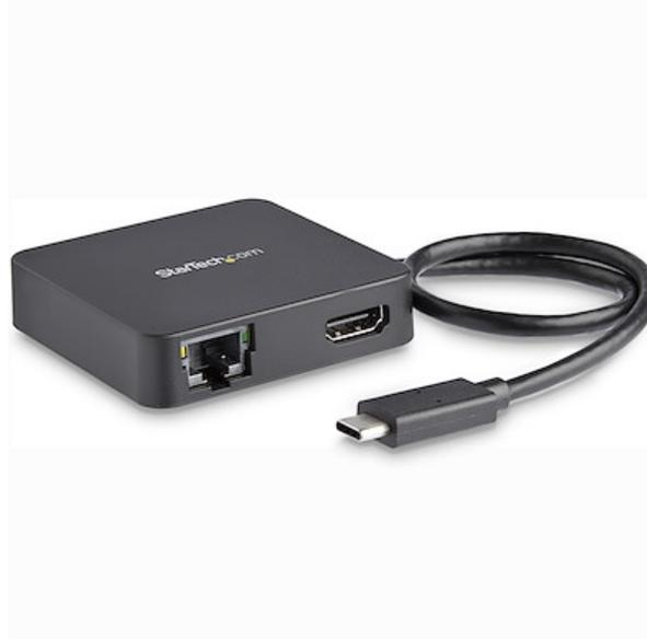
Cet adaptateur multiport USB-C avec HDMI combine les capacités de trois adaptateurs à fonction unique, un adaptateur vidéo USB-C, un adaptateur USB-C vers USB 3.0 et un adaptateur Gigabit Ethernet, dans une station d'accueil portable pour votre ordinateur portable. Vous pouvez connecter un écran HDMI 4K et deux périphériques USB 3.0 (1 USB-A et 1 USB-C), et accéder à un réseau haut débit, tout à travers un seul câble.
