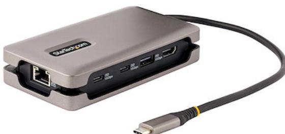
Questo adattatore multiporta USB-C con DP 1.4 supporta un'uscita video HDMI 4K 60Hz (HDR) e trasforma un laptop o un tablet USB-C in una workstation ovunque si ci trovi.
