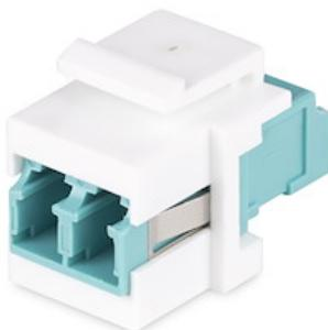
Connectez deux câbles à fibres optiques LC Duplex dotés d'embouts polis UPC pour étendre une connexion réseau à l'aide de ce coupleur Keystone LC vers LC. Ce coupleur à fibres optiques femelle-femelle maintient une intégrité de signal optimale tout en atteignant une perte d'insertion faible dépassant les normes de l'industrie.
