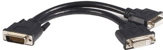
Este cable en Y DMS 59 a DVI de doble enlace permite dividir una conexión LFH 59 o LFH 60 (DMS 59 y DMS 60) de tarjetas gráficas Matrox Qid, nVidia Quadro, y PNY Quadro en dos conectores DVI-I hembra y así conectar dos monitores equipados con puertos DVI brindando una solución eficaz y económica de pantalla doble.
