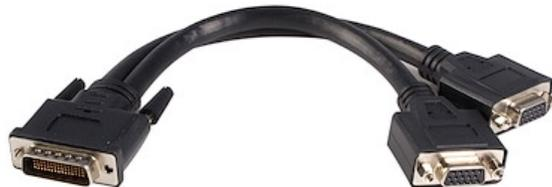
Este cable en Y DMS 59 a dos VGA permite dividir una conexión LFH 59 o LFH 60 (DMS 59 y DMS 60) de tarjetas Matrox Qid, nVidia Quadro, y PNY Quadro en dos conectores hembra DB15 de alta densidad, y así conectar dos monitores VGA brindando una solución eficaz y económica de pantalla doble.
