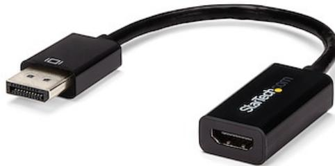
El adaptador DisplayPort a HDMI, modelo DP2HD4KS, permite la conexión de un PC de escritorio o portátil equipado con DisplayPort, como el modelo HP EliteBook 8570 p / 8470 p, a una pantalla HDMI. Este adaptador es compatible con DisplayPort 1.2 y HDMI 4K a 30 Hz; por tanto, admite resoluciones de vídeo de hasta Ultra HD (4K), así como el correspondiente audio digital con hasta 7.1 canales de sonido envolvente.
