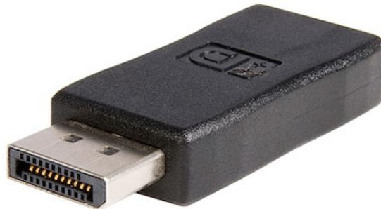
El adaptador de DisplayPort® a HDMI® DP2HDMIADAP proporciona un conector DisplayPort macho y HDMI hembra, lo que le permite conservar su pantalla (HDMI) actual mientras utiliza una tarjeta/fuente de vídeo DisplayPort.
