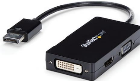
Il convertitore DisplayPort a VGA, DVI o HDMI DP2VGDVHD offre una compatta soluzione 3 in 1 per il collegamento del computer desktop, laptop o Ultrabook™ dotato di DP a un display VGA, DVI o HDMI.
