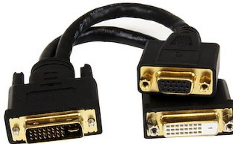
El cable divisor DVI Wyse, modelo DVI92030202L, incluye un conector DVI-I macho que se divide en un cable DVI-D hembra y en uno HD15 VGA hembra, a fin de conectar simultáneamente una pantalla o un proyector DVI-D y VGA a una terminal Wyse.
