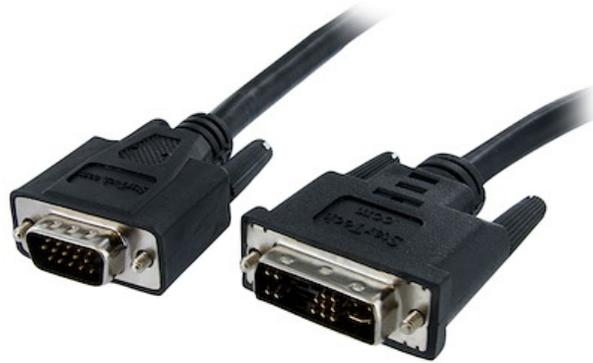
Il cavo per monitor DVI a display VGA DVIVGAMM5M (5 m) presenta un connettore maschio DVI-A e un connettore maschio VGA che consentono il collegamento di un display VGA a un computer PC o Mac® con uscita analogica DVI-I.
