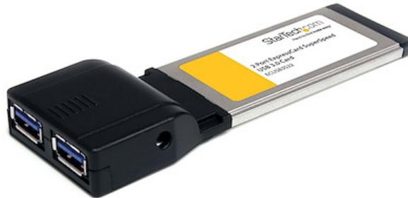
La Carte ExpressCard (USB 3.2 Gen 1) 2 ports ECUSB3S22 permet d'ajouter 2 ports SuperSpeed USB 3.2 Gen 1 à un ordinateur compatible ExpressCard, à l'aide d'un format de 34 mm pouvant être installé dans des slots de 34 mm et de 54 mm, ainsi que des ports montés côte à côte pour faciliter l'accès.
