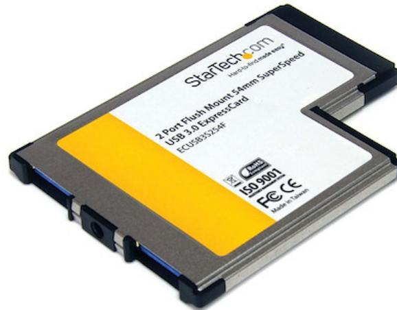
La tarjeta adaptadora ExpressCard USB 3.0 con 2 puertos y de montaje al ras, modelo ECUSB3S254F, permite agregar dos puertos USB 3.0 a un PC portátil equipado con ExpressCard.
