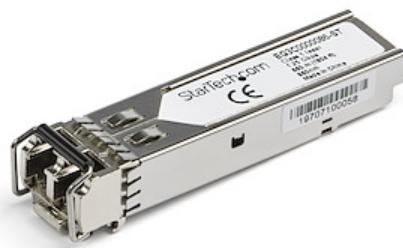
El modelo EG3C0000086-ST es un módulo transceptor SFP por fibra óptica compatible con el modelo EG3C0000086 de Citrix diseñado, programado y probado para su funcionamiento con routers y switches de la marca Citrix®. Ofrece conectividad fiable a 1 GbE, a través de cable de fibra óptica, para redes compatibles con 1000BASE-SX, a una distancia máxima de hasta 550 m.
