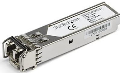
Le EG3C0000086-ST est un module de transceiver SFP fibre optique compatible Citrix EG3C0000086 qui a été conçu, programmé et testé pour fonctionner avec des commutateurs et des routeurs de marque Citrix®. Il vous assure une connectivité de 1 GbE par câble en fibre optique, sur les réseaux compatibles 1000BASE-SX et sur une distance maximale de 550 m.
