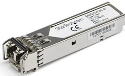
Il EG3C0000086-ST è un modulo ricetrasmettitore SFP in fibra compatibile con Citrix EG3C0000086 progettato, programmato e testato per funzionare con switch e router prodotti da Citrix®. Offre una connettività affidabile 1 GbE su cavo in fibra per le reti compatibili con 1000BASE-SX a una distanza massima di 550 m.
