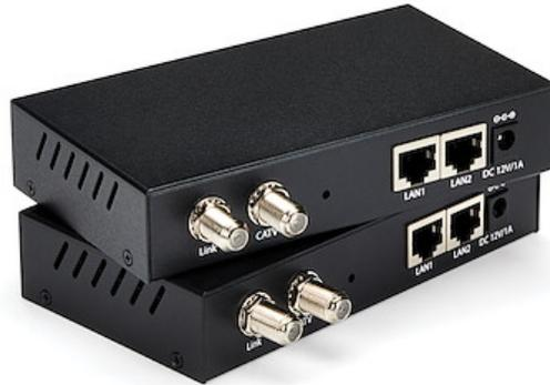
Il kit di estensione (2,4 km) della rete LAN Gigabit Ethernet su cavo coassiale senza gestione EOC1110K comprende i terminali e permette di estendere una rete Ethernet 10/100/1000 Mbps su lunghissime distanze (fino a 2,4 km) pur mantenendo un'alta velocità di connessione.
