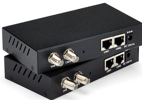
同軸ケーブル使用ギガビットイーサネットLANエクステンダキット(アンマネージド)。高速ネットワーク接続を保持しながら、非常に長い距離(最長2.4km)で10/100/1000Mbpsイーサネットネットワークを延長します。キットにはローカルとリモートの両ユニットが含まれています。
