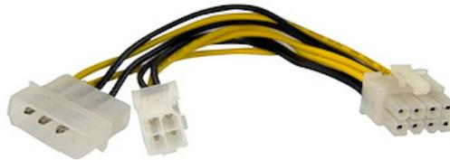
Este confiable adaptador EPS permite combinar una conexión de fuente de alimentación de 4 pines con una conexión de alimentación LP4 en un único conector EPS de 8 pines de la tarjeta madre, permitiendo usar una fuente de alimentación sin EPS con una tarjeta madre que requiere conexión de alimentación EPS.
