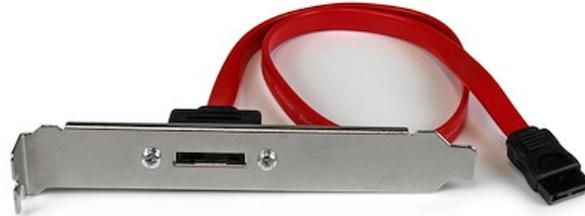
El adaptador de placa de 1 puerto SATA a eSATA (45 cm), modelo ESATAPLT18IN, agrega soporte externo para datos mediante un controlador serial ATA existente de la placa madre. Basta con instalar la placa en la parte trasera de la caja del ordenador, como extensión del conector de datos SATA de la placa madre, a fin de agregar un puerto que permita la conexión de dispositivos externos de almacenamiento SATA (por ejemplo, un disco duro eSATA).
