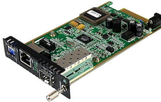
Il modulo scheda per convertitori multimediali in fibra SFP aperto ET91000SFP2C converte ed estende una connessione Gigabit Ethernet tramite fibra utilizzando l'SFP Gigabit scelto.
