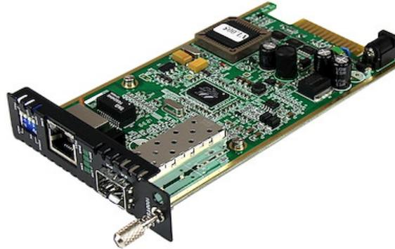
オープンSFPスロット光メディアコンバータ(カードモジュール)。任意のSFPを使用し、光ファイバを介してギガビットイーサネット接続を変換・延長します。
