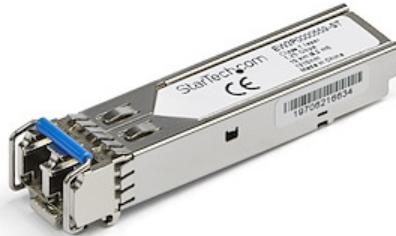
Le EW3P0000559-ST est un module de transceiver SFP fibre optique compatible Citrix EW3P0000559 qui a été conçu, programmé et testé pour fonctionner avec des commutateurs et des routeurs de marque Citrix®. Il vous assure une connectivité de 1 GbE par câble en fibre optique, sur les réseaux compatibles 1000BASE-LX et sur une distance maximale de 10 km.
