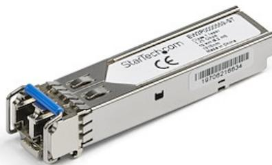
Il EW3P0000559-ST è un modulo ricetrasmettitore SFP in fibra compatibile con Citrix EW3P0000559 progettato, programmato e testato per funzionare con switch e router prodotti da Citrix®. Offre una connettività affidabile 1 GbE su cavo in fibra per le reti compatibili con 1000BASE-LX a una distanza massima di 10 km.
