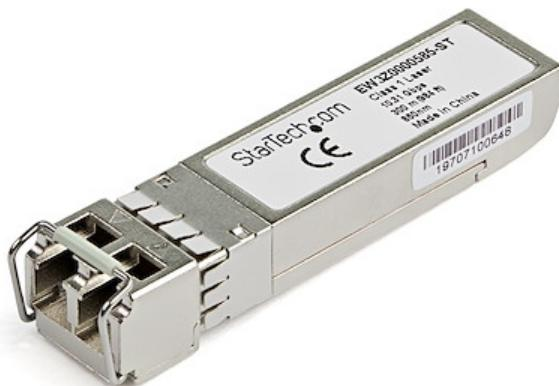
Der EW3Z0000585-ST ist ein Citrix EW3Z0000585-ST kompatibles Glasfaser SFP+-Transceiver-Modul, das für den Einsatz mit Citrix® Marken-Switches und -Routern entwickelt, programmiert und getestet wurde. Es sorgt für zuverlässige 10 GbE-Konnektivität über Glasfaser-Kabel für 10GBASE-SR-konforme Netzwerke mit einer maximalen Entfernung von bis zu 300m.
