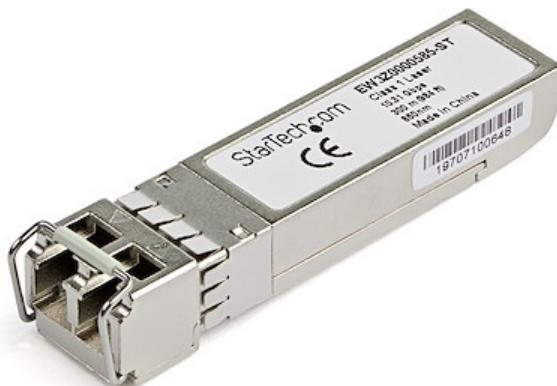
Le EW3Z0000585-ST est un module de transceiver SFP+ fibre optique compatible Citrix EW3Z0000585 qui a été conçu, programmé et testé pour fonctionner avec des commutateurs et des routeurs de marque Citrix®. Il vous assure une connectivité de 10 GbE par câble en fibre optique, sur les réseaux compatibles 10GBASE-SR et sur une distance maximale de 300 m.
