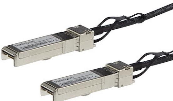
Il prodotto EXSFP10GE1M è un cavo SFP+ in rame a collegamento diretto, compatibile con Juniper EX-SFP-10GE-DAC-1M, progettato, programmato e testato per operare con switch e router a marchio Juniper®, nonché conforme agli standard MSA del settore.
