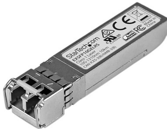
Il prodotto EXSFP10GELRS è un modulo ricetrasmittitore per fibra compatibile con Juniper EX-SFP-10GE-LR, progettato, programmato e testato per operare con switch e router a marchio Juniper®. Offre un'affidabile connettività da 10 GbE tramite cavo in fibra per le reti compatibili con 10GBASE-LR, a una distanza massima di 10 km.
