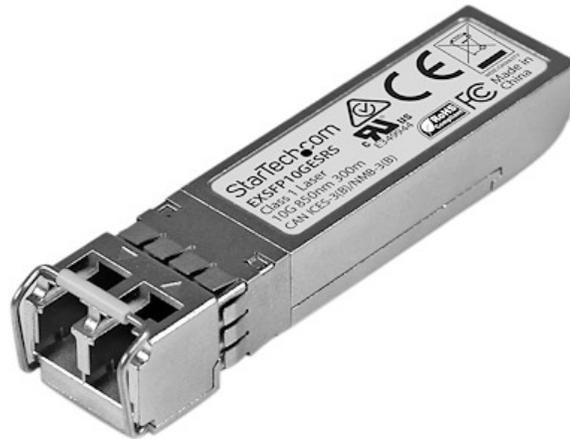
El modelo EXSFP10GESRS es un módulo transceptor por fibra óptica, compatible con el modelo EX-SFP-10GE-SR de Juniper, diseñado, programado y probado para su funcionamiento con enrutadores y conmutadores de la marca Juniper®. Ofrece conectividad 10GbE fiable a través de cable de fibra óptica para redes compatibles con 10GBASE-SR, con una distancia máxima de hasta 300m.
