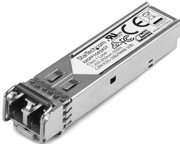
Das EXSFP1GELXST ist ein Juniper EX-SFP-1GE-LX-kompatibles Glasfaser-Transceiver-Modul, das speziell für die Zusammenarbeit mit Juniper®-Switches und -Router entwickelt, programmiert und getestet wurde. Es liefert zuverlässige 1-GbE-Konnektivität über Glasfaserkabel für 1000BASE-LX-konforme Netzwerke mit einer maximalen Entfernung von bis zu 10 km.
