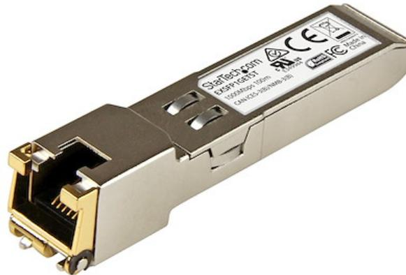
El modelo EXSFP1GETST es un módulo transceptor por cobre, compatible con el modelo EX-SFP-1GE-T de Juniper, diseñado, programado y probado para su funcionamiento con enrutadores y conmutadores de la marca Juniper®. Ofrece conectividad 1GbE fiable a través de cable de cobre para redes compatibles con 10BASE-T, 100BASE-TX y 1000BASE-T, con una distancia máxima de hasta 100m.
