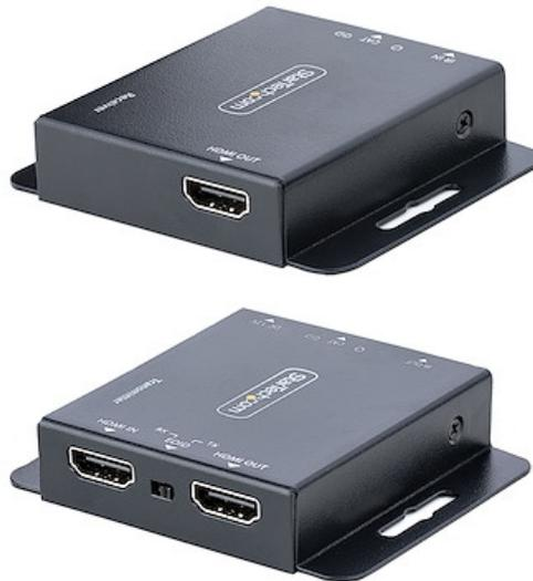
Este extensor HDMI® por CAT6 le permite transmitir una señal de audio-vídeo HDMI® de 4K 30Hz hasta 40m, o 70m para resoluciones de 1080p. Este kit conversor incluye tanto el transmisor como el receptor para una solución completa de extremo a extremo.
