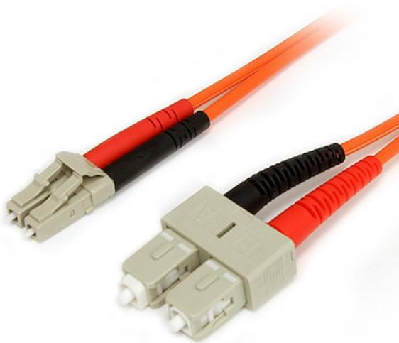
Il cavo patch duplex in fibra multimodale 62,5/125, 1 m FIBLCSC1 è dotato alle estremità di un connettore LC (maschio) e un connettore SC (maschio) che offrono il collegamento necessario tra dispositivi di rete a fibra per reti per lunghe distanze ad alta velocità.
