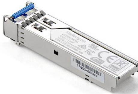
Das GLCEXSMDST ist ein Cisco-GLC-EX-SMD-kompatibles Glasfaser-Transceiver-Modul, das speziell für die Zusammenarbeit mit Cisco®-Switches und -Router entwickelt, programmiert und getestet wurde. Es liefert zuverlässige 1-GbE-Konnektivität über Glasfaserkabel für 1000BASE-EX-konforme Netzwerke mit einer maximalen Entfernung von bis zu 40 km.
