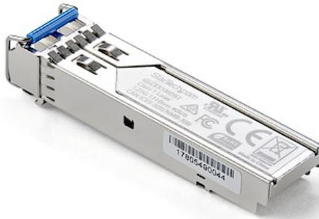
Il prodotto GLCEXSMDST è un modulo ricetrasmittitore per fibra compatibile con Cisco GLC-EX-SMD, progettato, programmato e testato per operare con switch e router a marchio Cisco®. Offre un'affidabile connettività da 1 GbE tramite cavo in fibra per le reti compatibili con 1000BASE-EX, a una distanza massima di 40 km.
