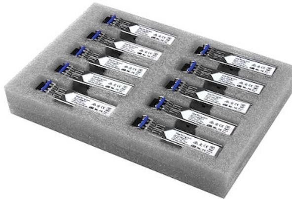
Il prodotto GLCLHSMD10ST è una confezione da dieci unità del nostro modulo ricetrasmettitore per fibra compatibile con Cisco GLC-LH-SMD, progettato, programmato e testato per operare con switch e router a marchio Cisco®. Offre un'affidabile connettività da 1 GbE tramite cavo in fibra per le reti compatibili con 1000BASE-LX/LH, a una distanza massima di 10 km.
