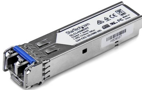
Il prodotto GLCLHSMDST è un modulo ricetrasmittitore per fibra compatibile con Cisco GLC-LH-SMD, progettato, programmato e testato per operare con switch e router a marchio Cisco®. Offre un'affidabile connettività da 1 GbE tramite cavo in fibra per le reti compatibili con 1000BASE-LX/LH, a una distanza massima di 10 km.
