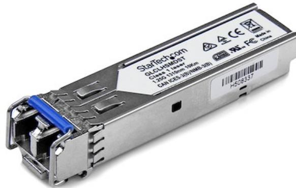
Cisco製GLC-LH-SMD互換SFPモジュール。Cisco®ブランドのスイッチやルーターでの使用を前提に、設計／プログラミング／検証が行われた製品です。光ファイバケーブルで最大10kmの距離に対応し、1000BASE-LX/LH準拠のネットワークで安定した1GbE接続を提供します。
