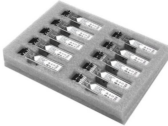
Il prodotto GLCSXMM10PST è una confezione da dieci unità del nostro modulo ricetrasmittitore per fibra compatibile con Cisco GLC-SH-MM, progettato, programmato e testato per operare con switch e router a marchio Cisco®. Offre un'affidabile connettività da 1 GbE tramite cavo in fibra per le reti compatibili con 1000BASE-SX, a una distanza massima di 550 m.
