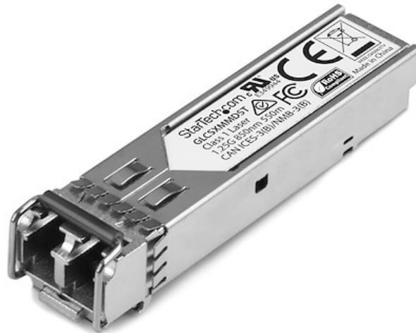
El modelo GLCSXMMMDST es un módulo transceptor por fibra óptica compatible con el modelo GLC-SX-MMD de Cisco, diseñado, programado y probado para su funcionamiento con enrutadores y conmutadores de la marca Cisco®. Ofrece conectividad confiable a 1GbE a través de cableado de fibra, para redes compatibles con 1000BASE-SX, a una distancia máxima de hasta 550m.
