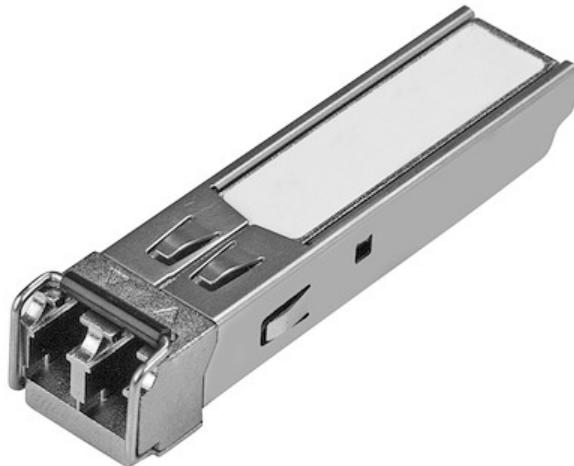
Le modèle GLCSXMMDST est un module de transceiver à fibre optique compatible avec Cisco GLC-SX-MMD conforme aux exigences TAA, qui a été conçu, programmé et testé pour fonctionner avec les commutateurs et routeurs de la marque Cisco®. Il fournit une connectivité 1 GbE fiable sur câble à fibre optique pour les réseaux conformes aux spécifications 1000BASE-SX, avec une distance maximale de 500 m.
