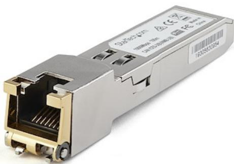
El modelo GLCTEST es un módulo transceptor por cobre compatible con el modelo GLC-TE de Cisco, diseñado, programado y probado para su funcionamiento con enrutadores y conmutadores de la marca Cisco®. Ofrece conectividad 1GbE fiable a través de cable de cobre para redes compatibles con 1000BASE-T, con una distancia máxima de hasta 100m.
