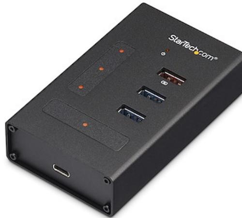
L'hub USB 3.2 Gen 1 a 4 porte consente di trasformare la porta USB-A del computer laptop o desktop in due porte USB-A standard, una porta USB-A per la ricarica rapida e una porta USB-C™. Può essere inoltre utilizzato come ripetitore intermedio per estendere la portata dei dispositivi USB.
