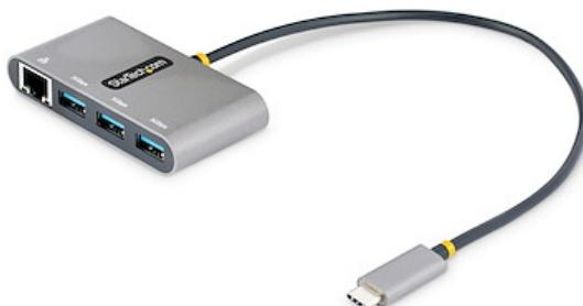
Questo hub USB-C con Ethernet Gigabit consente di aggiungere tre porte USB-A 3.2 Gen 1 (5Gbps) e una porta Lan Gigabit a un notebook con porta USB-Type C. L'hub USB alimentato via bus si collega a una porta USB Tipo-C di un computer portatile, utilizzando il cavo host integrato da 30 cm. Le dimensioni compatte di questo hub USB ne facilitano la portabilità in viaggio.
