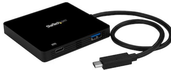
Mit diesem kompakten USB 3.0-Hub können Sie Ihrem Laptop drei USB-A-Ports hinzufügen, die USB Power Delivery unterstützen. Sie können Ihren Laptop also über seinen USB-C™-Port mit Strom versorgen und aufladen und gleichzeitig den Hub mit Strom versorgen.
